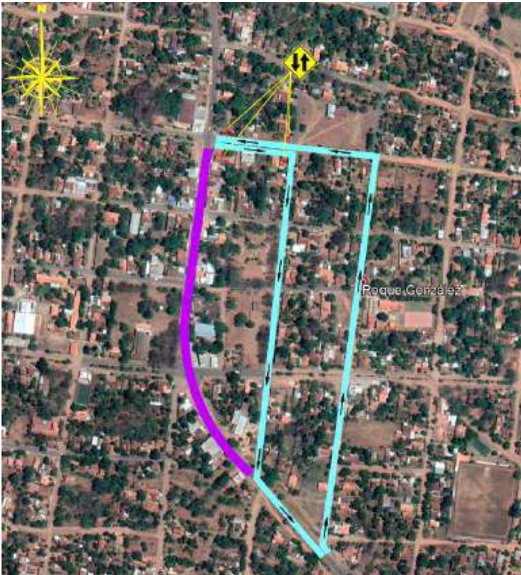
Figura 55: Croquis con la zona cortada al tráfico por obras y los desvíos en fase 1 de Desvíos Tipo VII.
