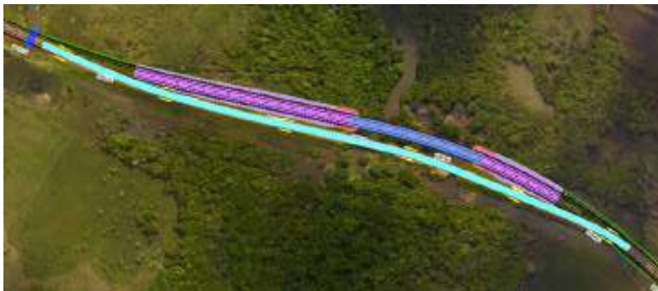
Figura 40: Zona de trabajos y desvíos Tipo I entre los Pr 76+660 y 77+170. Fuente: Elaboración propia.
