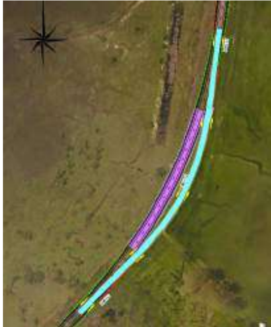
Figura 39: Zona de trabajos y desvíos Tipo I entre los Pr 71+600 y 71+820. Fuente: Elaboración propia.
